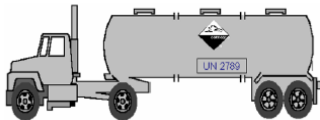
Figura 7.2. Ejemplo de rotulado para la Identificación de sustancias en tracto camiones
